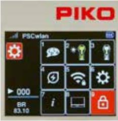
Um einzelne Bereiche des Controllers gegen unbefugtes Benutzen zu sichern, können diese in der Art verschlossen werden, dass sie nur über die Eingabe der vierstelligen PIN aktivierbar sind.
