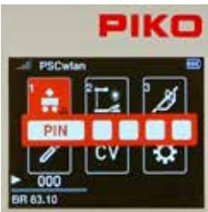
Wird nun im laufenden Betrieb ein verschlossener Bereich angewählt, so muss die PIN zum einmaligen Bedienen dieses Bereiches eingegeben und mit der „OK-Taste“ bestätigt werden. Dieses Menü ist nun bedienbar, bis es verlassen wird. Zum erneuten Aufrufen muss wieder die PIN eingegeben werden.
