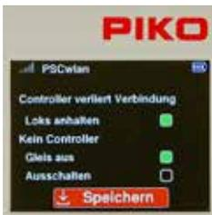
Über die nächsten Einträge kann festgelegt werden, ob nur das Gleis ausgeschaltet oder die SmartBox (Gleis und WLAN) ausgeschaltet werden soll, wenn der letzte Controller seine Verbindung zur Zentrale verliert. Im zweiten Fall kann die SmartBox über ihre Taste I wieder aktiviert werden. Ist auch hier keine der Möglichkeiten ausgewählt, bleibt alles im laufenden Betrieb, auch wenn kein Controller eine Verbindung zur Zentrale hat (hilfreich bei z.B. Schaufensteranlagen).
